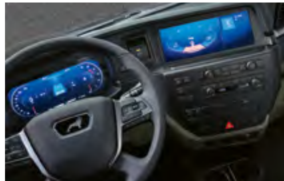
Infotainmentsysteem met 12"-scherm en bedieningspaneel onder het secundaire display
