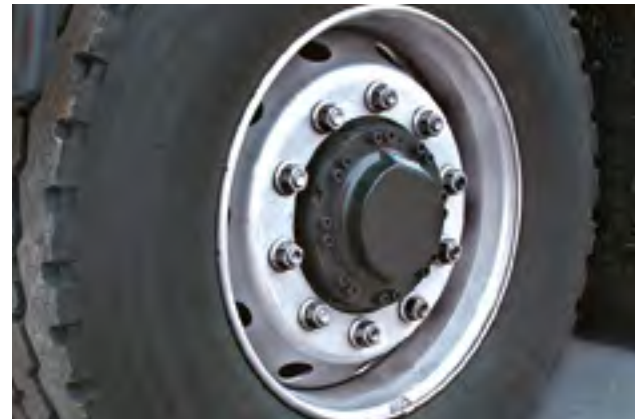
Vooras met hydrostatische wielnaafmotoren
